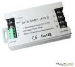
Amplificador de señal 30A para tiras LED hasta 4 canales (RGB) IP20, soporta hasta 360W a 12V y hasta 720W a 24V Necesario para instalación de tiras LED que superen los 10 metros de longitud o donde la señal necesita más potencia ya que las tiras pierden intensidad debido a la caída de tensión.
